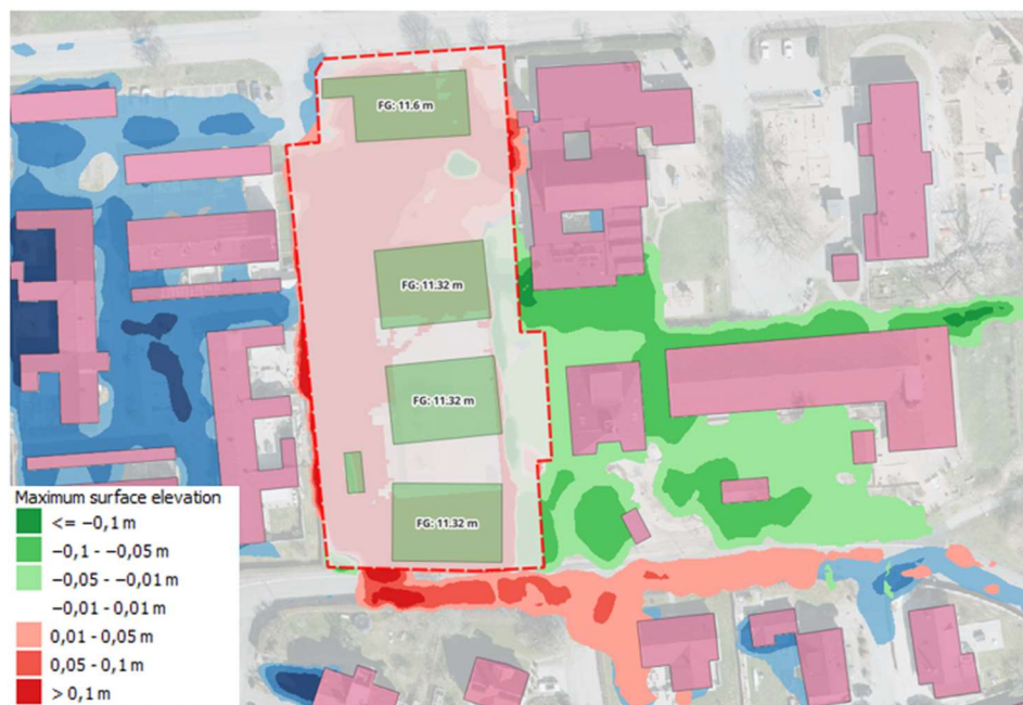
Figur 24: Skillnad i vattendjup mellan nulägesscenario och planförslaget. Röd färg visar förväntad vattennivåökning och grönfärg visar förväntad vattennivåsänkning.
