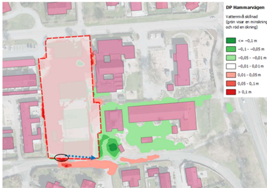
Figur 37 Karta med Vattennivå skillnad mellan nuläge och senaste förslaget. Röd färg motsvarar en vattennivåökning och grön färg en vattennivåminskning. Svarta cirkeln visar där det föreslår att höjsätta tröskelnivån vid +11,0 m och blåa streckade linjen visar placeringsförslaget till ett dagvatten ränna/dike med ca 300 l/s kapacitet.
