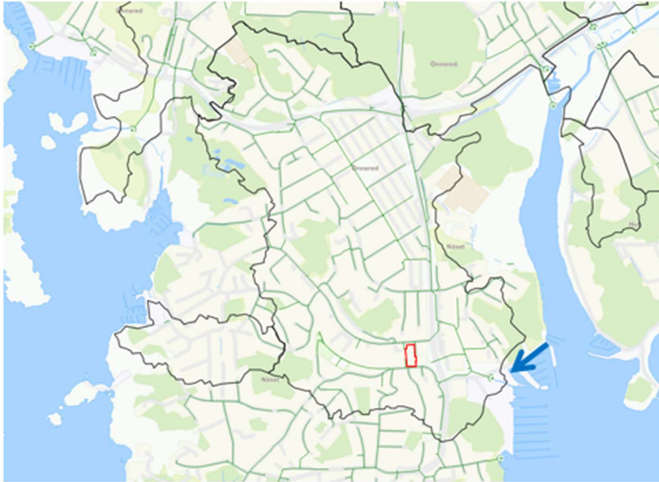
Figur 7 Karta över avrinningsområde. Dagvattennätet visas med gröna linjer, röd polygon markerar planområdets läge och blå pil visar dagvattenutloppet i Askims fjord. Bildkälla: Kretslopp Och Vatten, VA-banken, 2023
